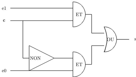
IV.D - Etant donné un diagramme de décision, on remplace chaque feuille par une sortie 0 ou 1 et chaque noeud interne par un multiplexeur dont la commande est branchée sur la variable correspondante et dont les entrées sont branchées sur les sorties de leurs successeurs. La sortie de la racine donne la valeur de la fonction booléenne (en fonction des valeurs des variables).
